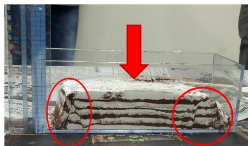
図7：実験で生じた正断層（両端に左右にクロスする断層）の様子
