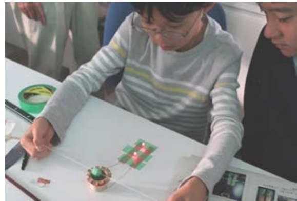
図6 回転する磁石をコイルに近づけて発電
