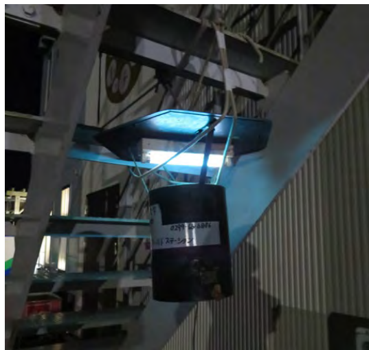
図2. 稼働状態のライトトラップ. トラップの下部にはファンが装着されており、灯火に集まった昆虫類が、トラップ内部にある籠の中に吸い込まれる。
