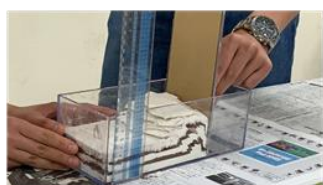
図2 断層形成実験の様子
