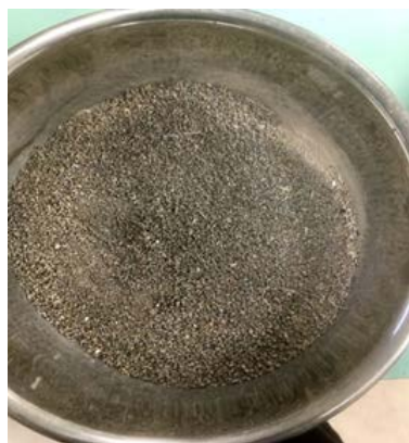
写真-2 焼却灰 2 mm ふるい通過分
