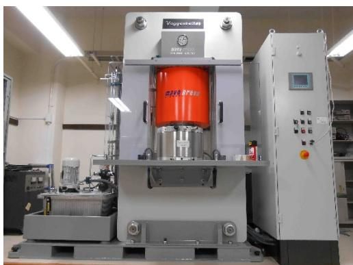
左の図：実験室の半分を占めるのがこの「超高压合成装置 MAVO」です。加圧には超硬合金 WC を用いて、20万気圧という圧力を実現しています。現在、化学分野も含め、新しい有機化合物や、ペロブスカイト酸化物、希土類ホウ化物等の新規機能性材料の開発を進めています。また、地球内部環境が再現できますので、地球科学における高圧環境での実証実験も可能です。
