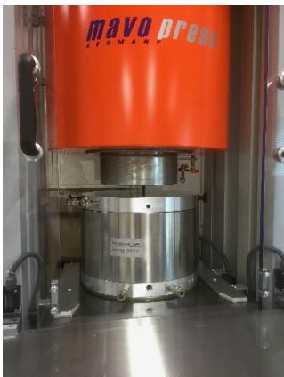
荷重は最大 1000 トンまで発生でき、試料まわりの加圧部品等の内部構造は複雑ですが、最大 20 GPa の加圧と加熱（最大 2000°C）を同時に実現しますので、まさに地球深部環境を再現できます。我々はこの環境下で新しい機能性材料の希土類ホウ化物の開発を目指しています。超伝導や機能性半導体等の興味深い物性を示すものが存在すると期待しています。今回は  $YB_{12}$  を母合金として、Nd を置換した合金の合成とその磁性等の物性を紹介します。
