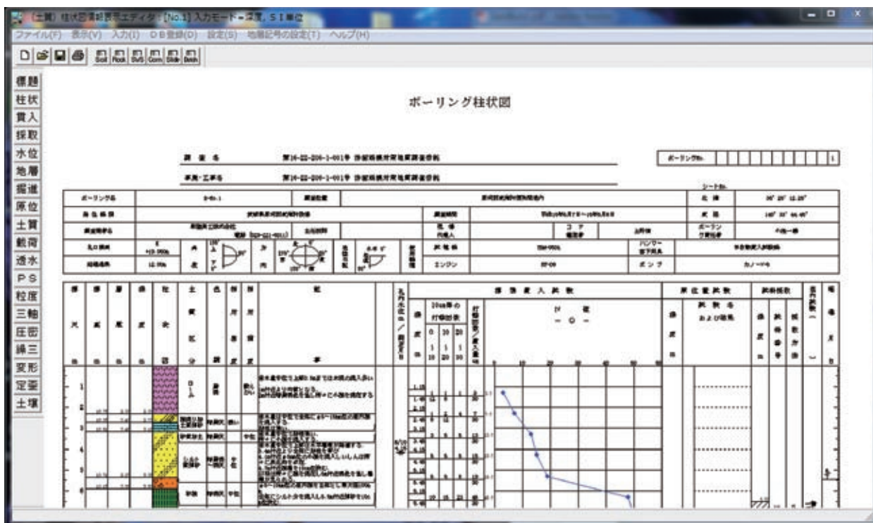
図6 ボーリング柱状図作成例
